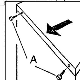
Выверните 2 верхних винта **A** и снимите крышку, двигая ее в горизонтальном направлении.
