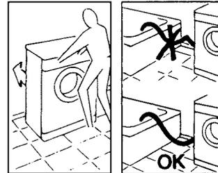
Придвиньте стиральную машину к стене. Закрепите сливной шланг на краю ванной, обращая внимание на то, чтобы отсутствовали перегибы или зажимы шланга.
