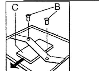
Выверните 2 винта **B** из фиксирующей перекладины и удалите из-под нее полистироловую прокладку **C**.
