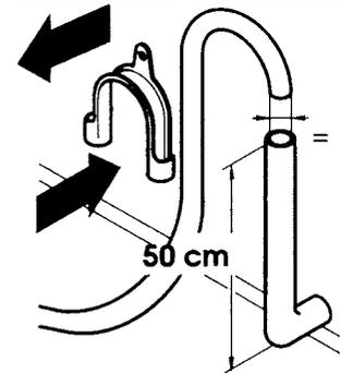
Зафиксируйте шланг слива воды (минимальная высота от уровня пола 50 см). Используйте фиксатор шланга слива воды, который поставляется в комплекте с машиной.
